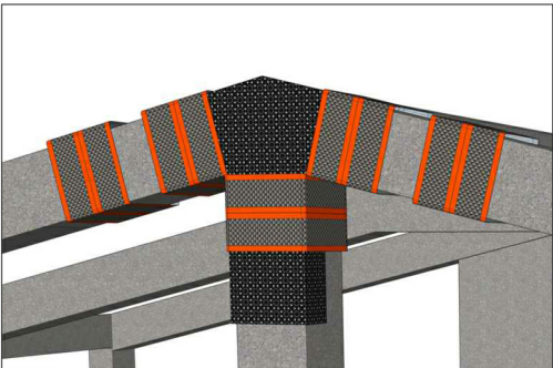
TAVOLA FRP 20 NODO DI COPERTURA Rinforzo strutturale di nodo di colmo fra pilastro e travi inclinate di copertura.
