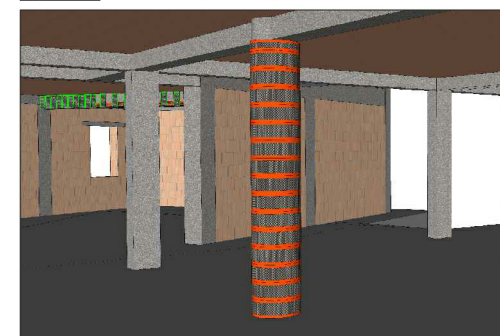
FRP 05 PILASTRO A SEZIONE CIRCOLARE Rinforzo strutturale di pilastro a sezione circolare con l'utilizzo di tubolari metallici
