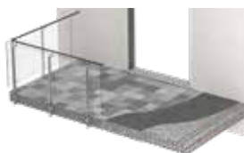
01 RIPRISTINO E RINGROSSO PER COLAGGIO
