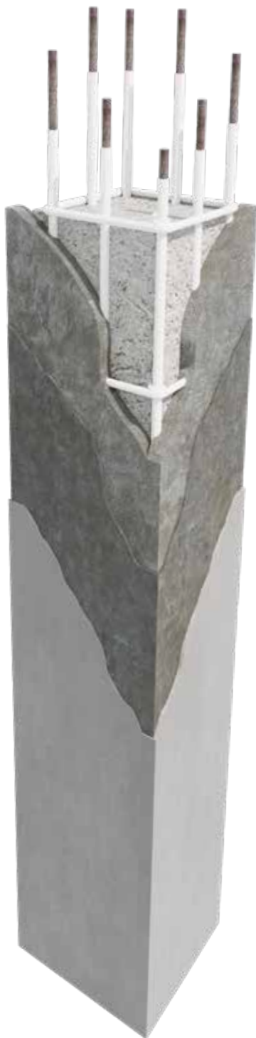
01 RICOSTRUZIONE DEL CALCESTRUZZO
