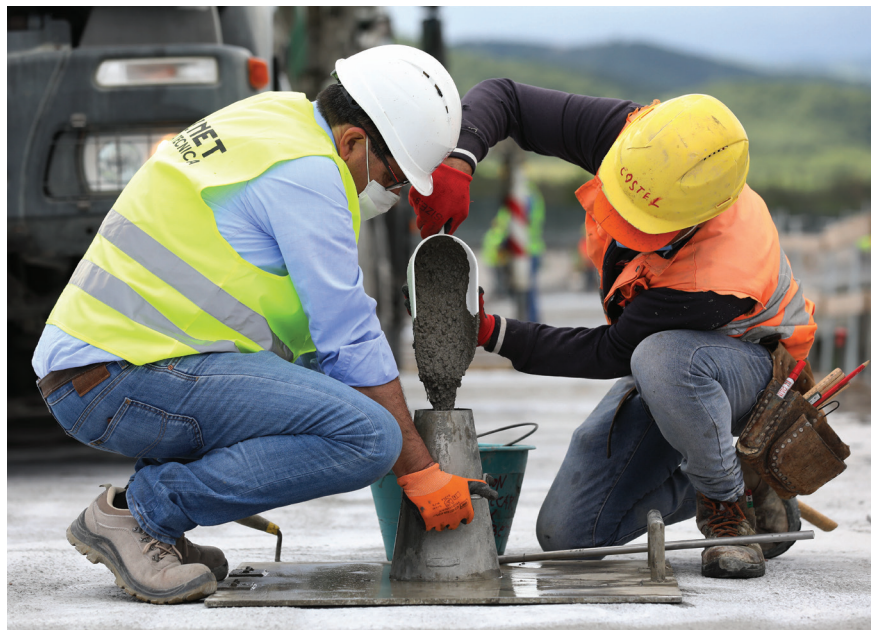
2A e 2B. Le prove in cantiere durante l'esecuzione dei getti a cura del servizio di assistenza Fibre Net
