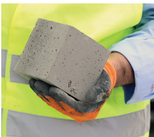
3. I provini del betoncino strutturale
