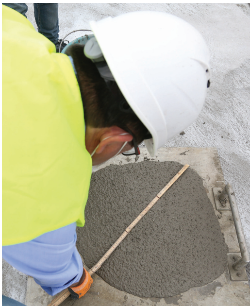
2A e 2B. Le prove in cantiere durante l'esecuzione dei getti a cura del servizio di assistenza Fibre Net
